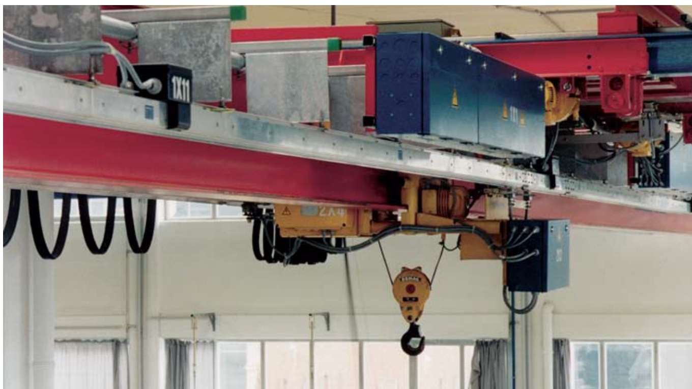
● Безопасный троллейный шинопровод LSVG на мостовом кране.
